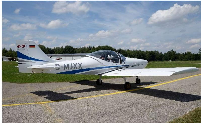
vorne rollt, dann muss die Luft an der Oberseite der Tragflächen einen längeren Weg zurücklegen als an der Unterseite, sie muss also schneller strömen. Das bedeutet aber, dass die Luft an der Oberseite dünner ist, also einen geringeren Druck hat als an der Unterseite. Dadurch entsteht eine Kraft, die wir Auftrieb nennen, und die das Flugzeug nach oben zieht.
